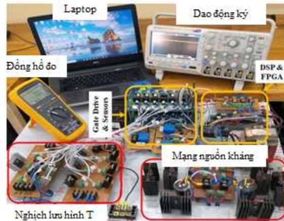
Hình 4.8: Mô hình thực nghiệm cho cấu hình 3L-qSBT 2 I-ECMV.
